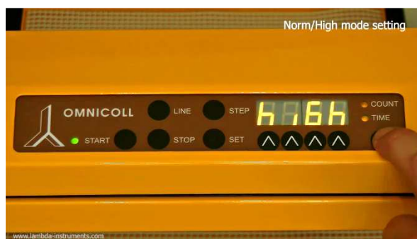
Obrázek 3.7-2 Pomocí tlačítka COUNT/TIME zvolte režim “high”.
