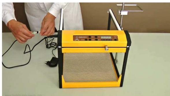
Obrázek 1.1-10 Spojte kabel kontrolní jednotky s kabelem napájecího zdroje.
