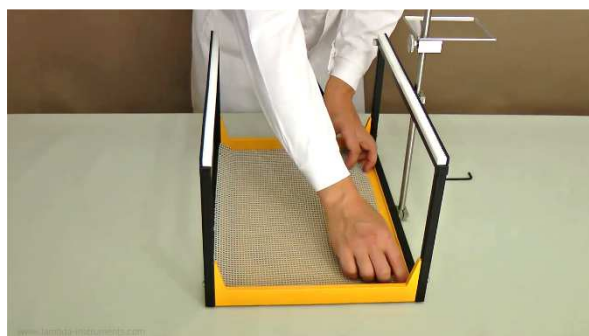
Obrázek 1.1-8 Vložte fixační podložku na dno podstavce. Tuto lepidivou podložku lze snadno regenerovat odstraněním prachu vlhkou hadrou nebo umytím ve vlažné vodě. Před použitím musí být podložka suchá.
