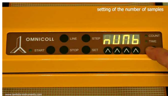
Obrázek 3.7-7 Volba parametru NUMBER (počet vzorků). [Count LED: nesvítí; Time LED: nesvítí; Displej: nUMb]
