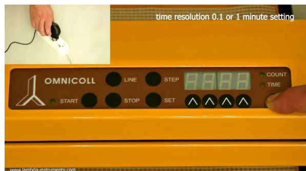
Obrázek 3.4-7 Stiskněte tlačítko „VÝBĚR“ a při stálém stisknutí současně zapněte napájení do sítě.
