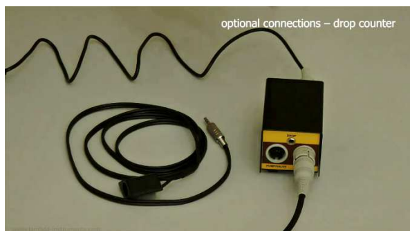
Obrázek 1.3-1 Detektor počítání kapek a propojovací komunikační modul (položka číslo: 6929).
