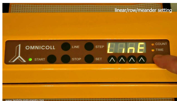
Obrázek 3.4-5 Pro lineární režim se objeví na displeji "Line".
