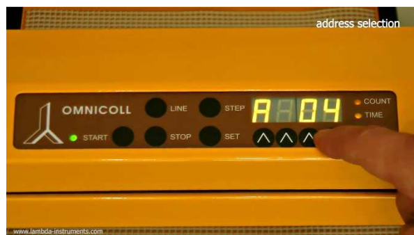
Obrázek 3.4-17 Pro změnu adresy stisknete tlačítka Λ Λ Λ Λ pod displejem, dokud není dosažena požadovaná hodnota.
