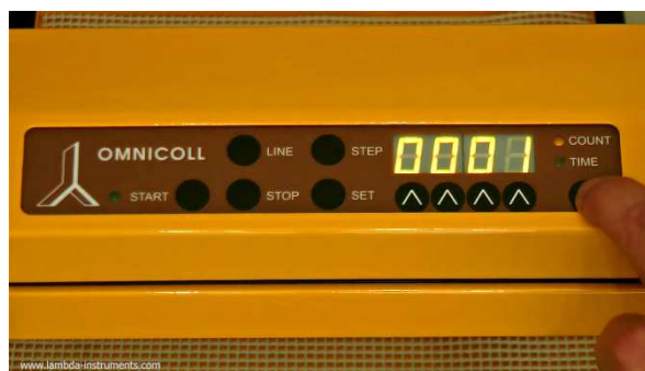
Obrázek 3.6-2 Pomocí tlačítka COUNT/TIME zvolte režim počítání (žlutá dioda vedle COUNT se rozsvítí).
