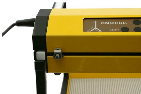
Obrázek 3.8-4 Odšroubujte vodící držák hadičky na pohybujícím se rameni OMNICOLLu.
