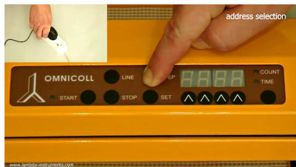
Obrázek 3.4-15 Stiskněte tlačítko STEP a při stálém stisknutí současně zapněte napájení do sítě.
