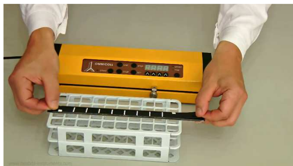
Obrázek 3.2-3 Vložte kratší kódovací pásek frakcí (x-osa) do držáku.
