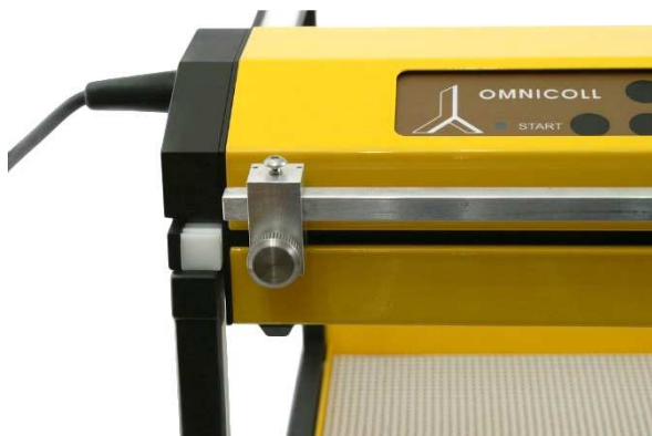
Obrázek 3.8-6 Vložte obdélníkovou tyč do držáku.
