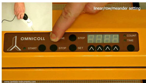
Obrázek 3.4-2 Stiskněte tlačítko „LINE“ a při stálém stisknutí současně zapněte napájení do sítě. Na displeji se objeví „Mod“ a následně posledně zvolený režim např. „rouu“.
