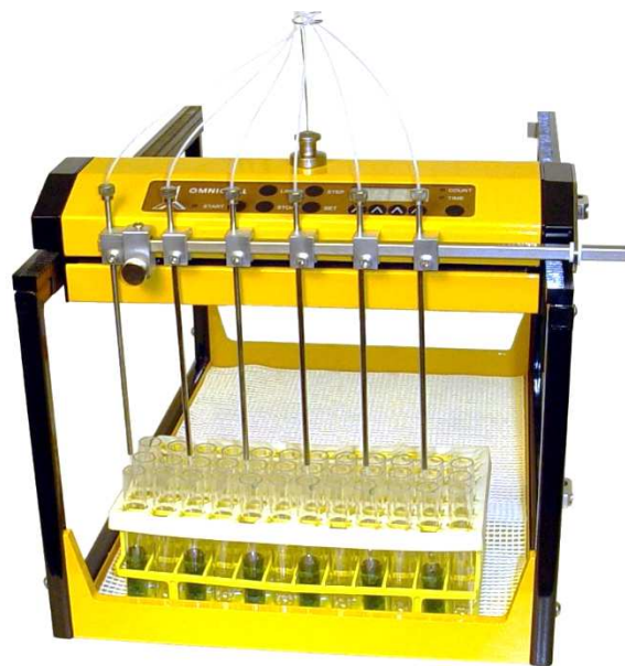
Obrázek 3.8-2 Ukázka 6kanálové konfigurace pro sběr frakcí v počtu 6x2.
