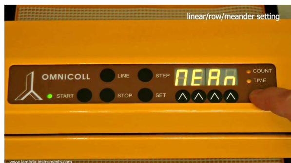
Obrázek 3.4-4 Pro meandrový sběr frakcí se objeví na displeji "Mean".
