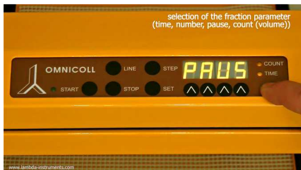
Obrázek 3.7-6 Volba parametru PAUSE (vložení pauzy). [Count LED: svítí; Time LED: svítí; Displej: PAUS]
