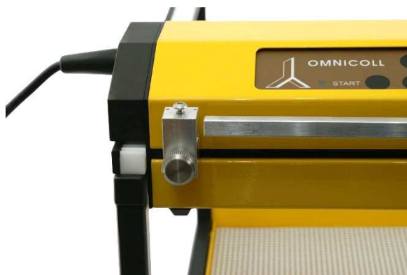
Obrázek 3.8-5 Přišroubujte držák pro obdélníkovou tyč.
