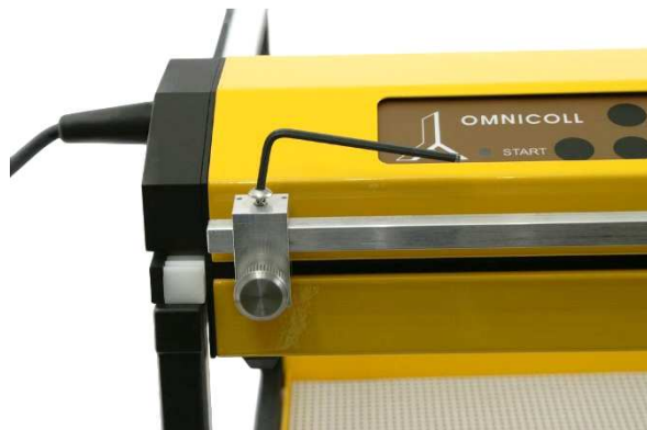
Obrázek 3.8-7 Přišroubujte držák na odpovídající pozici hexagonálním klíčem.
