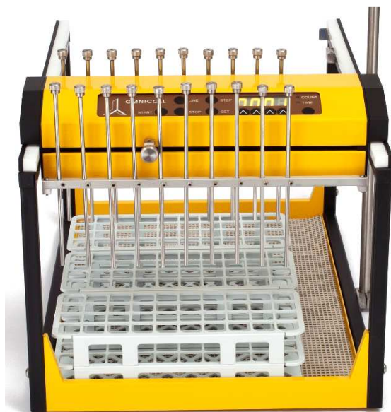
Obrázek 3.8-3 Ukázka 20kanálové konfigurace pro souběžný sběr 20-ti frakcí.
