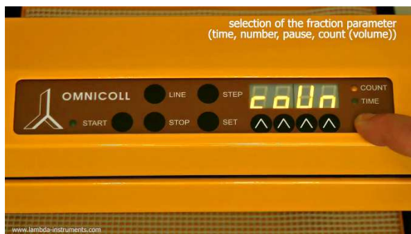
Obrázek 3.7-4 Volba parametru COUNT (objem). [Count LED: svítí; Time LED: nesvítí; Displej: coUn]
