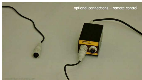
Obrázek 3.6-1 Peristaltická pumpa je připojena kabelem dálkového ovládání ke komunikačnímu modulu.
