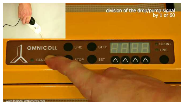
Obrázek 3.4-11 Stiskněte tlačítko START a při stálém stisknutí současně zapněte napájení do sítě.
