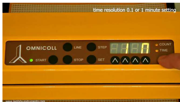
Obrázek 3.4-8 Nastavené časové rozlišení se objeví na displeji: "0,1M" nebo "1M".
