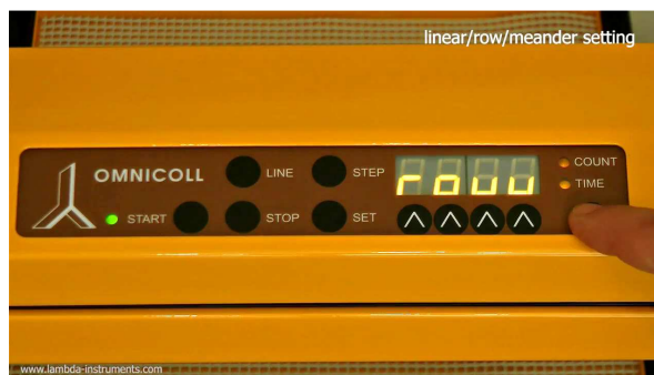
Obrázek 3.4-3. Stiskněte tlačítko VÝBĚR (pod COUNT / TIME) a zvolte požadovaný režim („Line“, „Mean“ nebo „rouu“).
