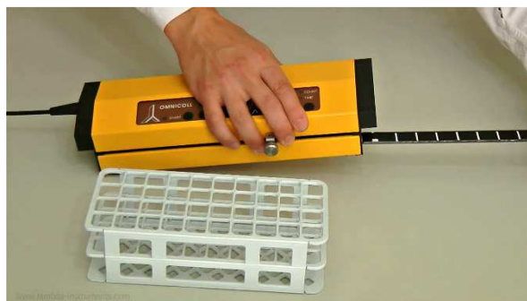
Obrázek 3.2-4 Zasaňte držák s páskem zpět do vozíku až do zaklapnutí.
