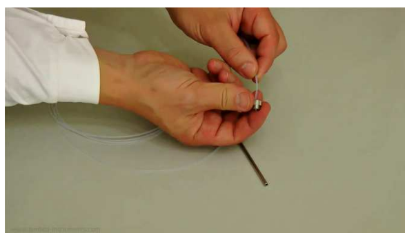
Obrázek 1.2-2 Nasadte na hadičku černé těsnění neboli O-kroužek a provlečte dodanou PTFE hadičku přes vodící trubičku tak, aby vyčnívala asi 5 mm.
