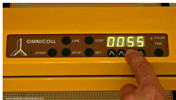
Obrázek 3.6-3 Vyberte požadovaný počet pomocí tlačítek Λ Λ Λ Λ pod displejem, například: 55.
