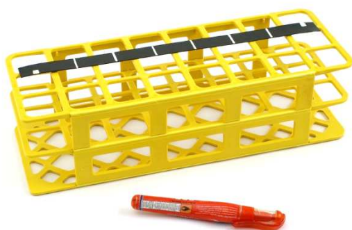
Obrázek 3.1-3 Začátek a konec řady je označen krátkou čarou (přibližně do poloviny magnetické pásky, čára je široká cca 5 mm). Začátek řady je indikován čarou vedoucí od spodního okraje pásky a konec řady čarou vedoucí od horního kraje pásky.
