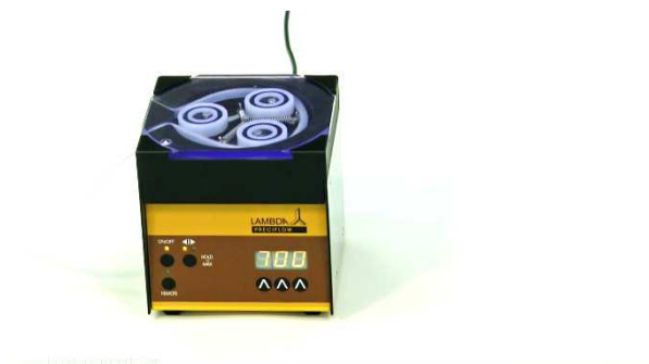
Obrázek 3.6-5 Na pumpě nastavte libovolnou hodnotu rychlosti, např. 700, zvolte směr otáčení a zapněte pumpu (pumpa je prozatím blokována kolektorem).
