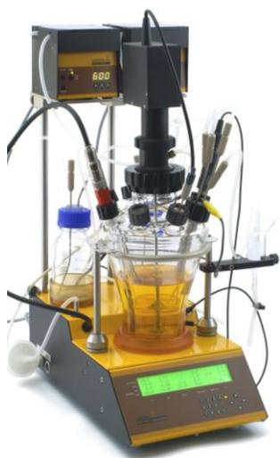
7. 溶氧控制: 可滅菌之 Clark 式溶氧電極, 具快速反應及強化之 Teflon 薄膜
