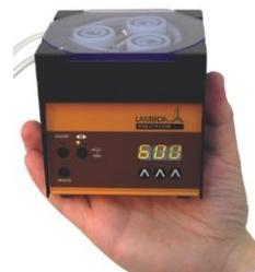
1. 說明: 可連續自動添加液體藥劑, 使用蠕動幫浦使液體以準確定量、連續添加於發酵槽中
