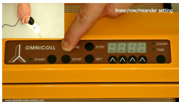
Figura 3.4-1 Presione el botón LINE mientras conecta la fuente de energía a la toma principal. Presionando el botón SELECTION (debajo de COUNT/TIME) seleccione el modo de colección.
