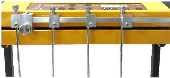
Figura 3.8-10 Coloque el soporte de guías de tubos en la posición de fracción deseada y asegúrelas por los tornillos de cabeza usando la llave hexagonal correspondiente (Allen).
