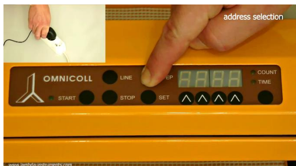
Figura 3.4-14 Mientras mantiene presionado el botón de dirección STEP conecte el equipo a la red eléctrica.
