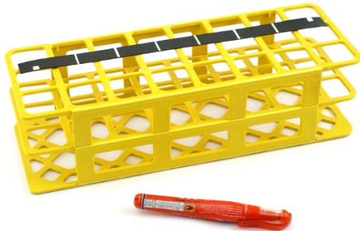
Figura 3.1-3 El inicio y el final de una fila son indicados por líneas cortas (alrededor de la mitad de la longitud de las bandas normales o menos y ~5 mm de ancho) hechas en el borde inferior (para el inicio) y en el borde superior (en el final) de la banda codificadora, respectivamente.
