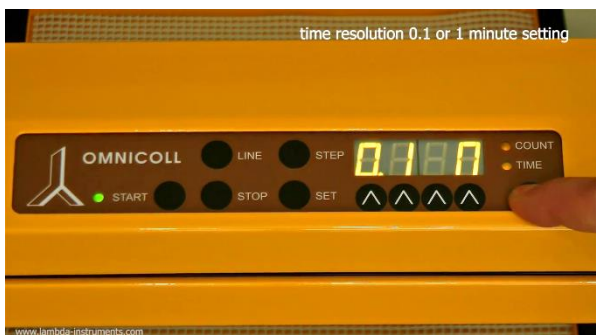
Figura 3.4-8 Presionando el botón COUNT / TIME debajo de los LEDs COUNT y TIME Ud puede seleccionar usar pasos de 0.1 minuto “0.1M” o pasos de 1 minuto “1M”.
