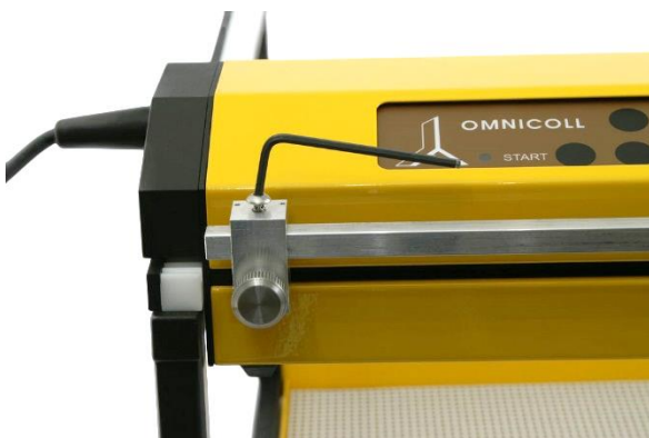
Figura 3.8-8 Atornille el soporte de la barra en el brazo móvil del colector de fracciones con la llave del enchufe correspondiente (llave-hex). Use por ejemplo una espátula delgada para empujar el tornillo a través del brazo móvil.
