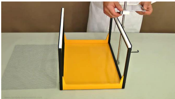
Figura 1.1-7 Empuje el barra de metal a través de los dos aditamentos en el lado derecho del marco y asegúrelas con tornillos. Si lo necesita entonces fije la placa sostenedora a esta barra.
