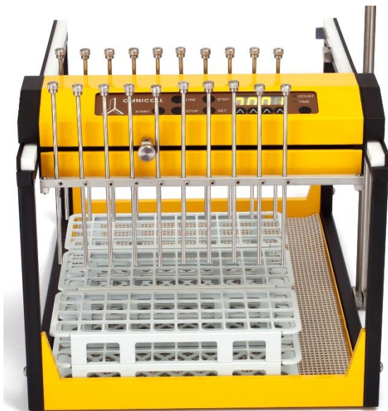
Figura 3.8-3 Ejemplo de la toma simultánea de 20 fracciones en una configuración de 20-canales .
