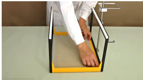
Figura 1.1-8 Coloque el tapete antideslizante bien extendido en la placa base. Si fuera necesario, limpie previamente el tapete antideslizante con un paño húmedo para mejor adherencia. Asegúrese de que el tapete esté completamente seco antes de su uso.
