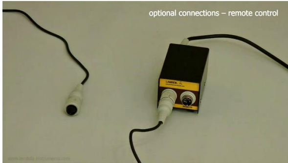
Figura 3.6-1 Conecte el cable de control remoto de la bomba peristáltica al módulo de comunicación.
