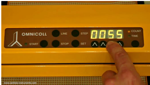
Figura 3.6-3 Seleccione el número de conteo deseado con los botones de flechas ^ ^ ^ ^ debajo de la pantalla Ej.: 55.
