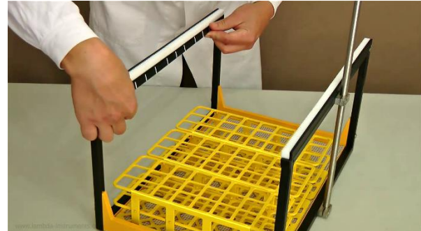
Figura 3.3-6 Coloque la banda codificadora magnética en la cara interna izquierda del marco de metal justo debajo de la corredera dentada.
