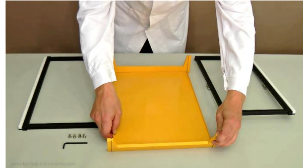
Figura 1.1-2 Empuje la segunda pieza sostenedora en las ranuras por el lado corto opuesto restante de la base amarilla.
