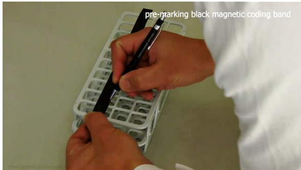
Figura 3.3-1 Coloque las bandas codificadoras magnéticas sobre la gradilla y marque la posición de la colección con un lápiz normal.
