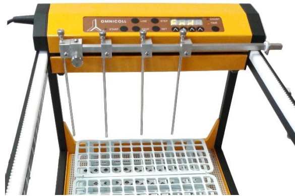
Figura 3.8-11 Coloque el soporte de las guías de tubos en posición sobre la primera fracción de cada flujo (canal).
