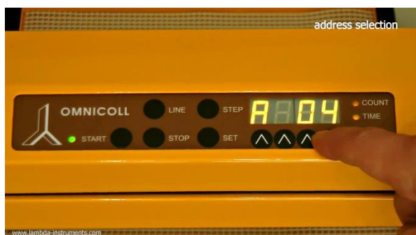
Figura 3.4-16 Para cambiar la dirección presione los botones de flechas debajo de la pantalla hasta llegar al deseado.
