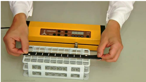
Figura 3.2-3 Coloque la banda magnética corta y ancha en el soporte para el eje X.
