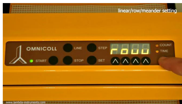
Figura 3.4-2 El mensaje “ rouu ” para el modo de filas aparece en la pantalla, cuando se continúa presionando el botón SELECTION .
