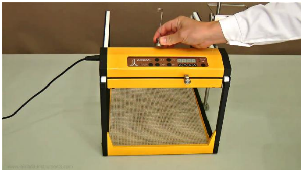
Figura 1.2-1 Coloque el sostenedor magnético del tubo o manguera convenientemente en el centro de la carcasa del colector de fracciones y unidad de control.
