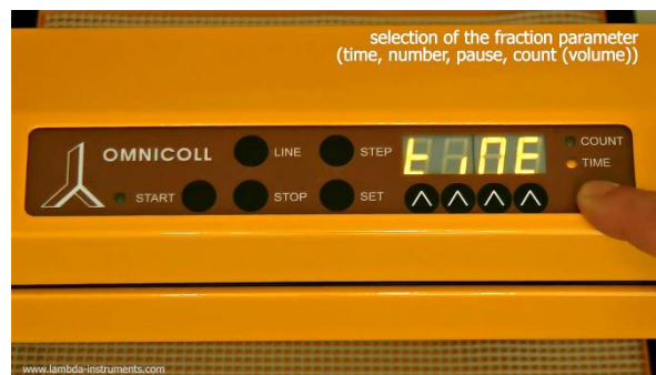
Figura 3.7-5 Seleccione el parámetro TIME para ejecutar el programa para un tiempo deseado. [LED del Count: apagado OFF; LED del Time: encendido ON; Pantalla: tiMe]
