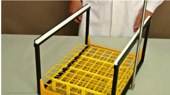
Figura 3.3-5 Marque la distancia de la fila con un lápiz en la banda codificadora para el eje Y y dibuje las líneas blancas con el corrector suministrado.
