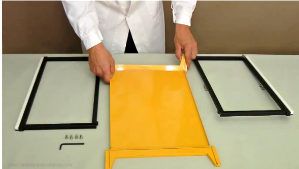
Figura 1.1-1 Empuje una de las piezas sostenedoras de la base inferior de metal en las ranuras por el lado corto de la base amarilla.
