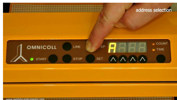
Figura 3.4-15 El mensaje “A” y dos números aparecerán en la pantalla. Este número desde 00 hasta 99 es la dirección actual del colector de fracciones.
