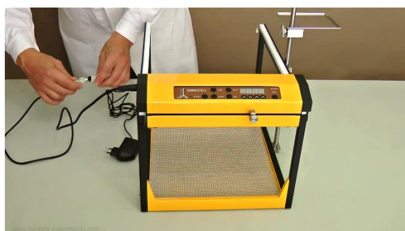
Figura 1.1-10 Conecte el cable de la unidad de control del colector de fracciones LAMBDA OMNICOLL con el cable para la fuente de energía.
