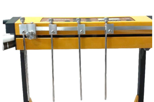
Figura 3.8-9 Deslice las guías metálicas de los tubos en el soporte de guías de tubos, de forma de lograr una altura conveniente sobre los tubos. Fije estas guías de tubos a su soporte usando la llave hexagonal correspondiente.
