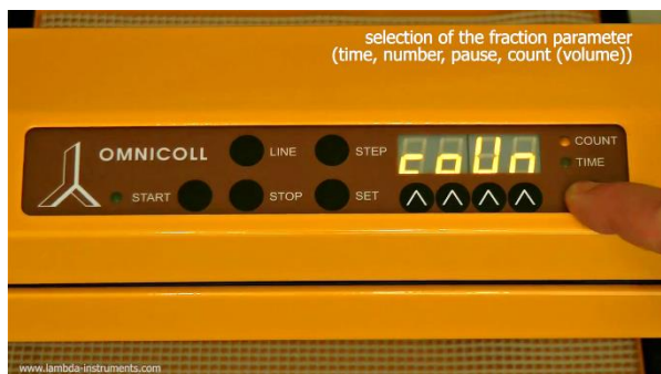
Figura 3.7-4 Seleccione el parámetro COUNT (volumen). [LED del Count: encendido ON; LED del Time: apagado OFF; Pantalla: coUn]
