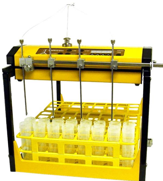
Figura 3.8-1 Ejemplo de la toma de fracciones de 4x2 en una configuración de 4-canales .
