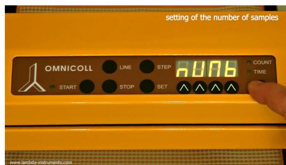
Figura 3.7-7 Seleccione el parámetro NUMBER para coleccionar un número de muestras. [LED del Count: apagado OFF; LED del Time: apagado OFF; Pantalla: nUMb]
