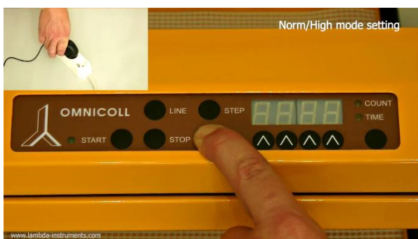
Figura 3.7-1 Presione el botón SET en la unidad de control y a la vez conéctela a la red eléctrica.
