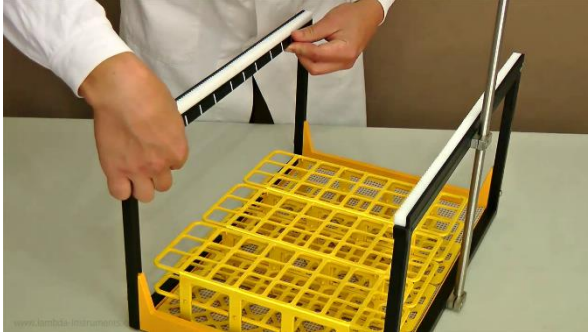
Figura 3.2-1 Coloque la banda codificadora larga y estrecha (eje Y) en la parte interior del marco izquierdo metálico debajo de la corredera dentada como se muestra. La primera línea blanca debe estar alrededor de 10 cm de la parte frontal del marco.
