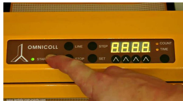
Figura 3.6-6 Presione el botón START en el colector para iniciar la colección de fracciones. Si la manguera no se llenó del todo con el líquido, tome una segunda fracción/muestra.
