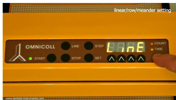
Figura 3.4-4 El mensaje “ Line ” es para el modo de colección lineal.
