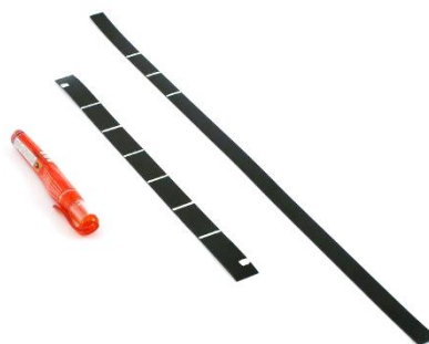
Figura 3.1-2 Las posiciones de las fracciones son indicadas con líneas blancas dibujadas en la banda magnética codificadora negra como se muestra.
