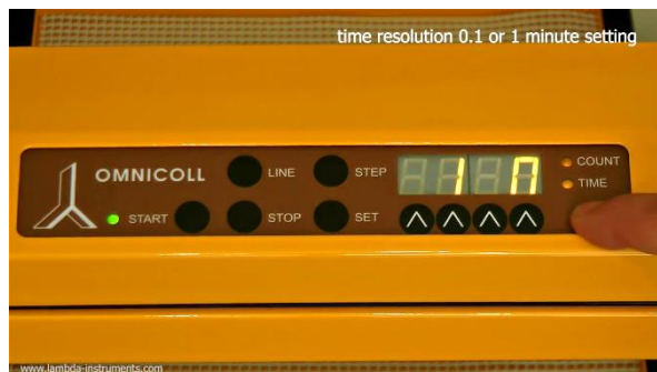
Figura 3.4-7 La resolución del tiempo real aparecerá en la pantalla “0.1M” o “1M”.
