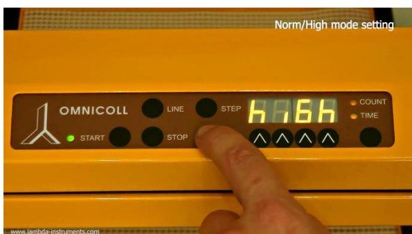
Figura 3.7-3 Confirme su selección presionando el botón SET (escuchará una larga señal beep).
