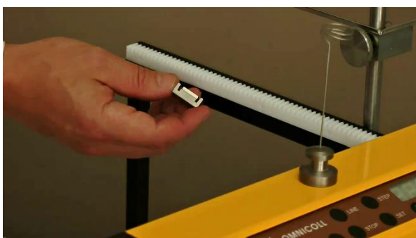
Figura 1.1-11 Coloque el magneto o imán que se suministra en el lado derecho interno del marco para detener la colección de fracciones.
