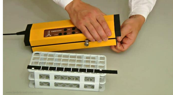
Figura 3.2-2 Tire del soporte para la banda codificadora magnética del eje X de la unidad de control del OMNICOLL como se muestra.
