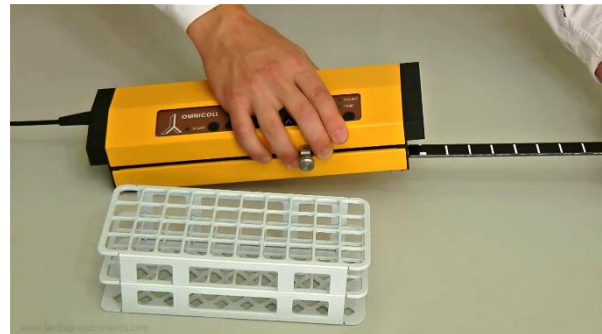
Figura 3.2-4 Inserte el soporte del eje X con la banda magnética codificadora dentro de la ranura de la unidad de control, con las líneas blancas hacia arriba.
