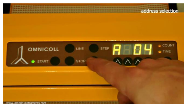
Figura 3.4-17 Confirme la selección presionando el botón SET
