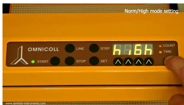
Figura 3.7-2 Use el botón COUNT/TIME para seleccionar el modo “high”.
