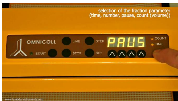
Figura 3.7-6 Seleccione el parámetro PAUSE (pausa) para introducir pausas en el programa. [LED del Count: encendido ON; LED del Time: encendido ON; Pantalla: PAUS]
