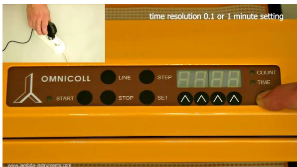
Figura 3.4-6 Presione el botón COUNT/TIME mientras conecta la fuente de energía a la toma principal.
