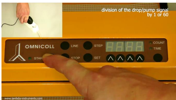
Figura 3.4-10 Presione el botón START mientras conecta el cable a la red eléctrica.
