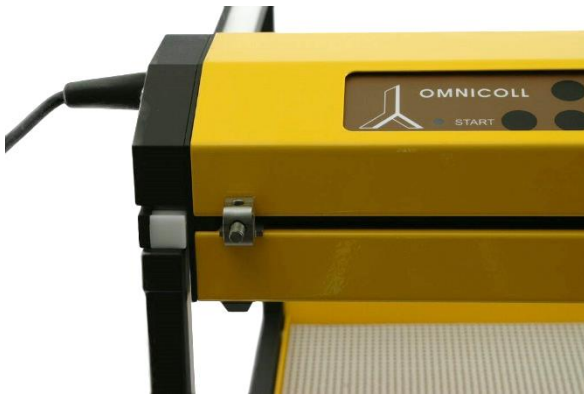
Figura 3.8-4 Desensrosque el tornillo del soporte para la guía metálica del tubo en el brazo móvil del colector de fracciones OMNICOLL.
