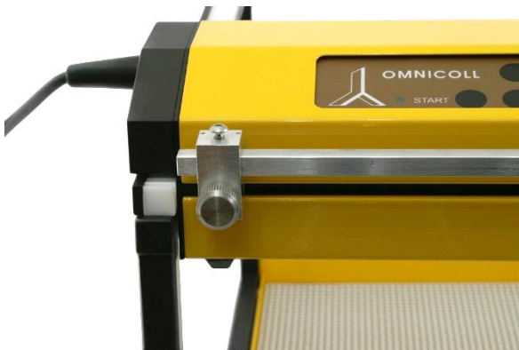
Figura 3.8-6 Inserte la barra rectangular dentro del soporte de la barra como se muestra.
