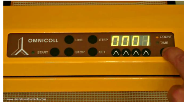
Figura 3.6-2 Con el botón COUNT/TIME , seleccione el modo de conteo (COUN) (LED amarillo COUNT encendido).
