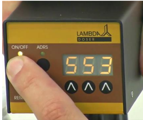
Figura 1-14: Presione el botón On/Off en la unidad del motor después de seleccionar la velocidad de dosificación.
