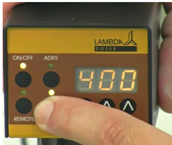
Figura 2-16: Para comenzar el programa presione el botón RUN . En este momento estarán encendidos los LED de los botones RUN y ON/OFF .
