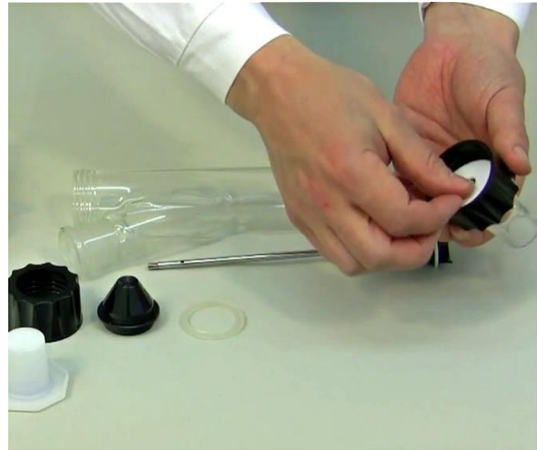
Figura 1-2: Ponga el disco de Teflón dentro de la tapa con rosca y colóquelo sobre la superficie plana del adaptador de vidrio con ajuste o boca esmerilada.
