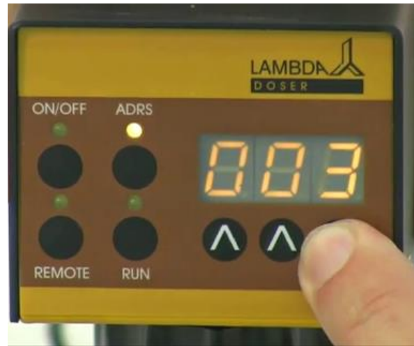
Figura 2-6: Seleccione el periodo de tiempo deseado para el primer paso del programa presionando los botones de flechas debajo de la pantalla ▲▲ (desde 0 hasta 999 minutos o 00.0 hasta 99.9 minutos). Presionando el botón ADRS , el tiempo de resolución puede ser ajustado en 0.1 minutos. En el tiempo de resolución de 0.1 minuto se muestra un punto entre los dígitos. ej. “00.1”.
