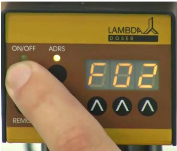
Figura 2-7: Pulse el botón ON/OFF . La indicación “F02” aparecerá brevemente en la pantalla.
