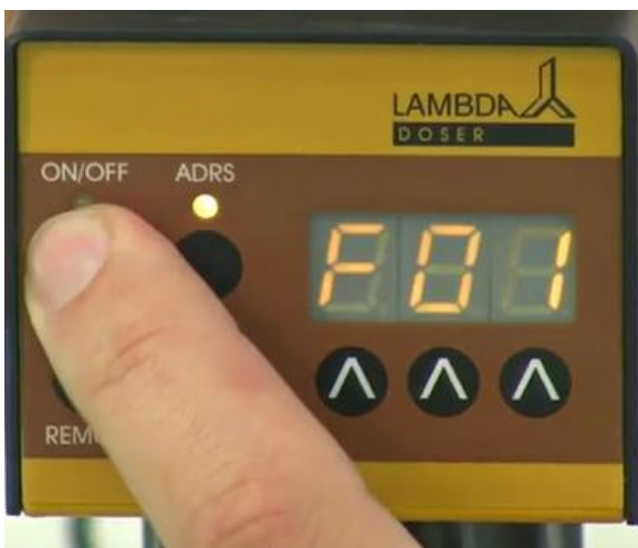
Figura 2-3: Presione el botón ON/OFF . La señal "F01" aparecerá brevemente en la
