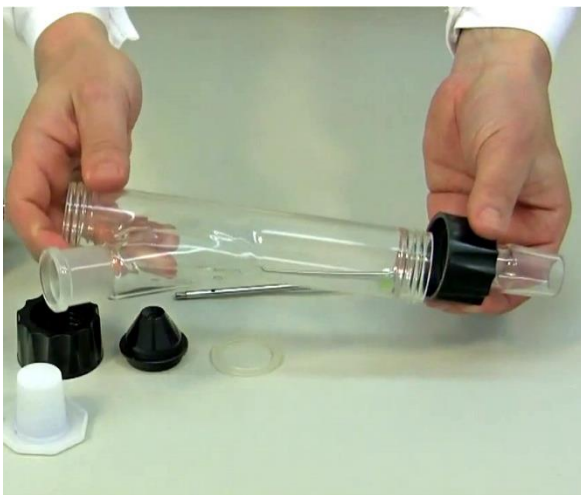
Figura 1-3: Tome el arreglo de piezas anteriores y enrósquelo al recipiente de vidrio con brazo lateral del DOSER 0.2L.
