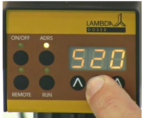
Figura 2-8: Ahora puede entrar el valor de velocidad de flujo o caudal deseado para el segundo paso.
