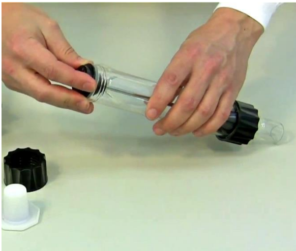
Figura 1-7: Coloque la pieza centradora del eje distribuidor con el sellador de goma en el eje del distribuidor.
