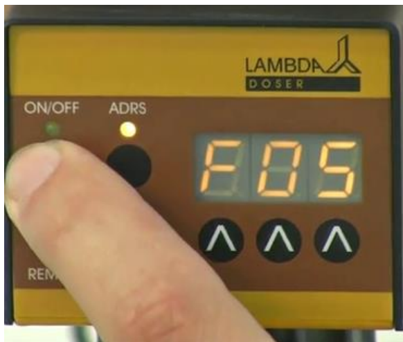
Figura 2-11: Después de haber entrado el tiempo para el último paso, presione el botón ON/OFF . La velocidad de flujo o caudal (000) del próximo paso, la cual no debe ser programada aparece en la pantalla. Ejemplo: “F05”
