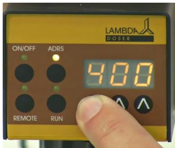
Figura 2-4: Pulse los botones debajo de la pantalla para establecer el valor de caudal
