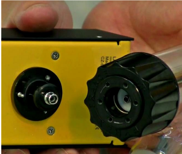
Figura 1-9: Eje de la unidad del motor con punta saliente de metal y pieza centradora del eje distribuidor con seis huecos o hendiduras.
