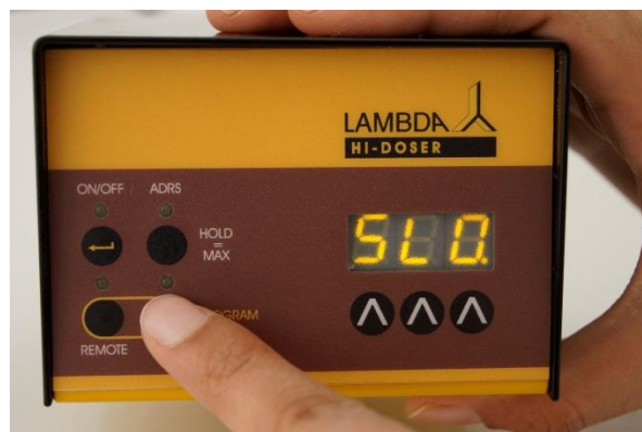
Figura 1-16 Presione el botón RUN para seleccionar el modo de operación deseado ( FAS / SLO ). Confirme y salve el modo seleccionado presionando el botón ON/OFF en el panel de control.
