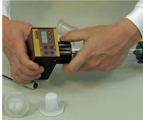
Figura 1-10: Presione el eje de la unidad del motor hacia dentro de la pieza centradora del eje distribuidor completamente. De esta forma el saliente de metal de la unidad del motor encajará en una de las hendiduras de la pieza mencionada. Esto asegura un sellado perfecto y presión suficiente del distribuidor contra el disco de Teflón en el fondo del recipiente de vidrio con brazo lateral del DOSER o HI-DOSER.
