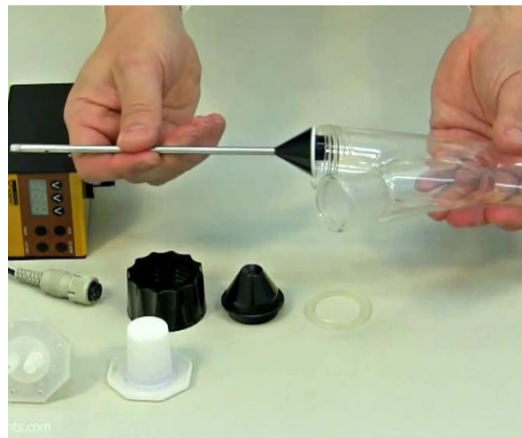
Figura 1-4: Inserte el distribuidor estándar dentro del tubo de vidrio con su abertura directamente hacia abajo de manera tal que este no se dañe.
