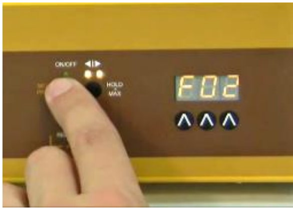
Figura 2-9: Pulse el botón ON/OFF . La indicación "F02" aparecerá brevemente en la pantalla.
