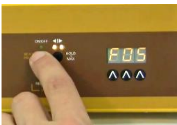
Figura 2-13: Después de entrar el tiempo del último paso, presione el botón ON/OFF . La velocidad de flujo (000) del próximo paso no será programada y entonces aparece en la pantalla el mensaje. Ejemplo: "F05"
