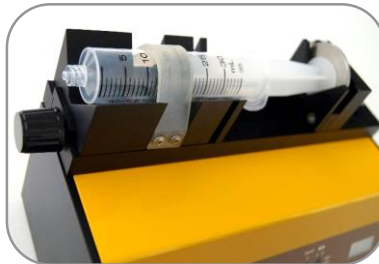
Cama para la jeringa o jeringuilla, banda fijadora de silicona y perilla o tornillo rotatorio para fijar la parte superior de la jeringa o jeringuilla
