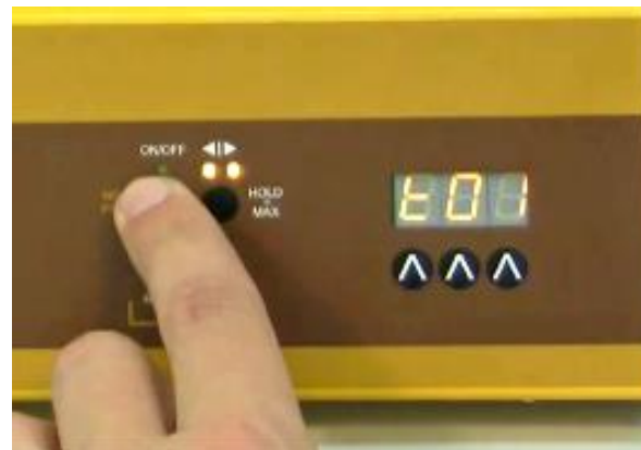
Figura 2-6: Pulse el botón ON/OFF . La señal “t01” aparecerá brevemente en la pantalla. Ya puede ingresar el tiempo en minutos para el primer paso.
