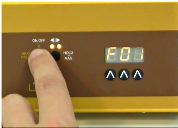
Figura 2-3: Pulse el botón ON/OFF . La señal “F01” aparecerá brevemente en la pantalla indicando que ya se puede seleccionar el primer valor de caudal (velocidad).
