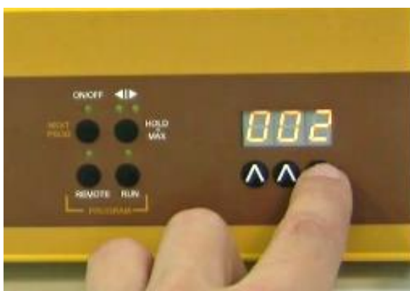
Figura 2-7: Con los botones Λ Λ Λ localizados debajo de la pantalla, seleccione el período de tiempo deseado para el primer paso del programa (de 0 a 999 minutos o 00.0 hasta 99.9 minutos)
