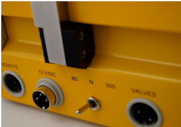
Figura 1-1 Enchufe el conector de la fuente de alimentación en el enchufe correspondiente (12 V/CD) en la parte posterior de la bomba y gire el anillo para ajustarlo.
