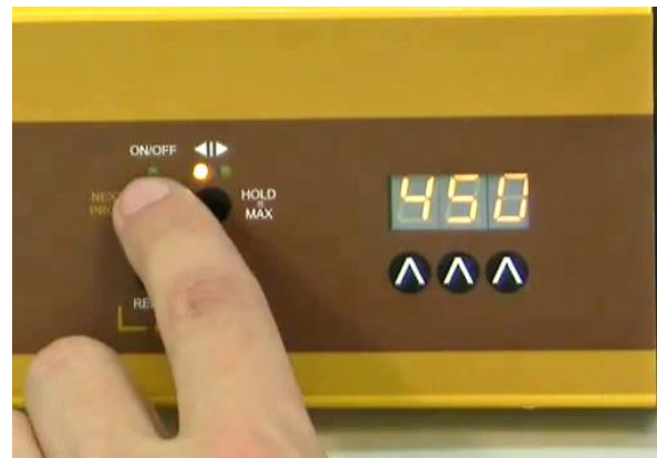
Figura 1-10: Después de seleccionar la velocidad presione el botón ON/OFF de encendido y apagado
