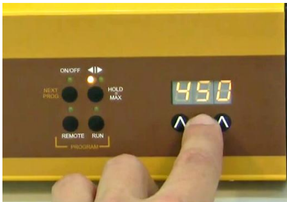
Figura 1-9: Seleccione la velocidad del motor con la ayuda de los botones ▲ ▲ ▲.
