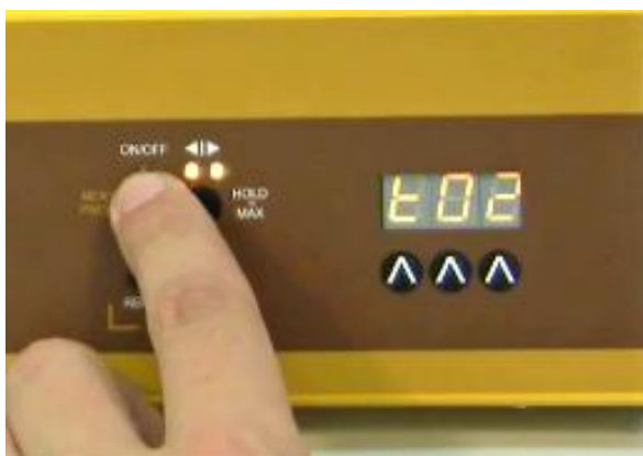
Figura 2-11: Pulse el botón ON/OFF nuevamente. La señal "t02" aparecerá brevemente en la pantalla.
