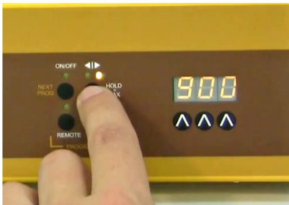
Figura 2-5: Seleccione la dirección del impulsor de la bomba (para infusión o llenado) con los botones de dirección ◀|▶ .
