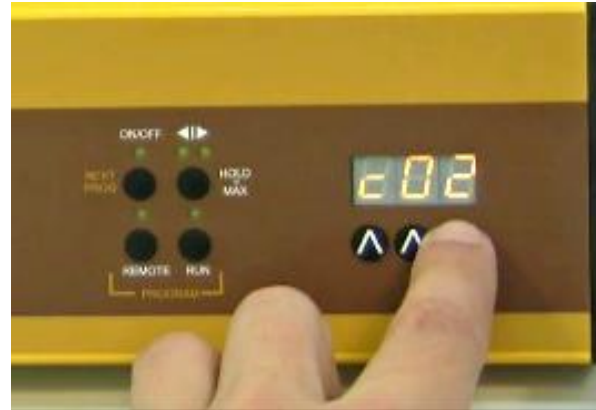
Figura 2-16: Si desea repetir el mismo programa dos veces, incremente el número de ciclos a “c02” presionando los botones de flechas ▲▲▲ ubicados debajo de la pantalla (ciclos desde 0 hasta 99). El programa puede ser repetido hasta 99 veces indicando “c99”. Si Ud entrase el número 0 lo que es igual a “c00”, el programa estará ejecutándose de manera continua ( lazo infinito ).
