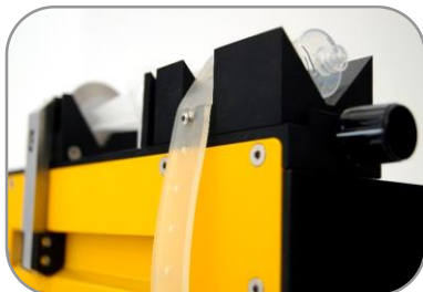
Banda fijadora flexible de silicona para la fijación de diferentes tipos de cuerpos de jeringas o jeringuillas a la bomba
