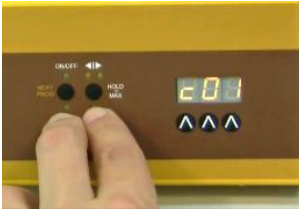
Figura 2-15: Presione simultáneamente los botones REMOTE y RUN y verá la indicación “c01” en la pantalla. Esto indica que el programa será ejecutado solo una vez y el dosificador de polvos se detendrá después.
