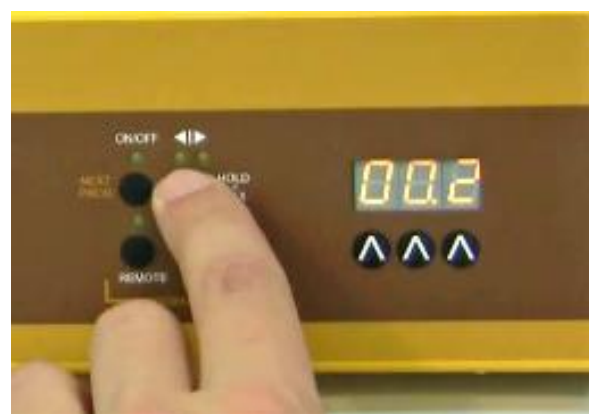
Figura 2-8: Presionando el botón de dirección ( ◀|▶ ), el tiempo de resolución puede ser ajustado en 0.1 minutos. En el tiempo de resolución de 0.1 minuto se muestra un punto entre los dígitos. ej. “00.1”. El tiempo de resolución puede ajustarse individualmente para cada paso del programa.
