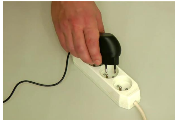
Figura 1-2 Enchufe la fuente de alimentación universal conmutada (90-250V / 50-60Hz) al tomacorriente. Luego de una corta señal acústica, la pantalla se iluminará. La última configuración establecida aparecerá en la pantalla.
