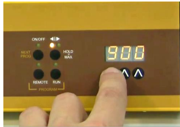
Figura 2-4: Con los botones Λ Λ Λ localizados debajo de la pantalla, establezca el valor de caudal deseado para el primer paso (0 a 999, que representa 0 a 100% de la velocidad del motor).
