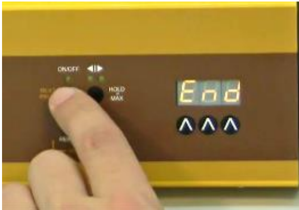
Figura 2-17: Presione nuevamente el botón ON/OFF hasta que la indicación “End” aparezca en la pantalla para confirmar y salvar el programa.
