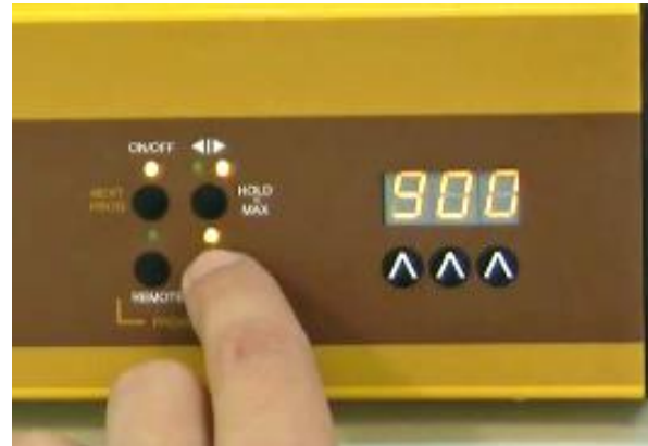
Figura 2-18: Para comenzar el programa presione el botón RUN . En este momento estarán encendidos los LED de los botones RUN y ON/OFF .
