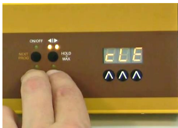
Figura 2-2: Pulse simultáneamente los botones REMOTE y RUN nuevamente incluso después que la indicación "PGM" desaparezca, la memoria se borrará y la señal "cLE" aparecerá en la pantalla
