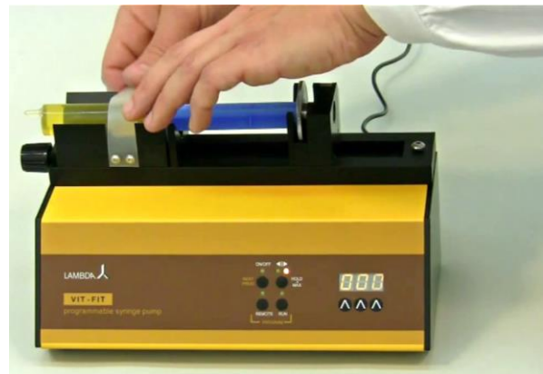
Figura 1-8 Ajuste el cuerpo de la jeringuilla usando la banda de fijación elástica.
