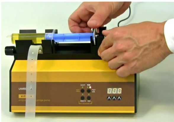
Figura 1-7 Gire el disco fijador para ajustar y restringir el movimiento del extremo del impulsor.
